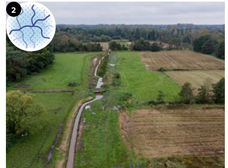
Afb. 9.17. Scherpenberg – De Hutten : Scherpenbergloop was te diep ingesneden en de natuurlijke verbinding met de vallei was verloren. Daardoor droogde de beek het gebied uit en waren er maatregelen nodig om het waterpeil omhoog te brengen: verhogen van de beekbodem en versmallen van de beek met aanleg van een zomer/winterbed.
